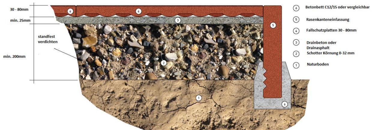
**Bei nicht drainagefähigem Beton oder Asphalt ist ein Gefälle von ca. 2% mit freier Drainage vorzusehen.**
